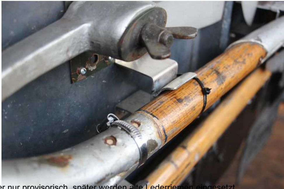
Kabelbinder nur provisorisch, später werden alte Lederriemen eingesetzt
